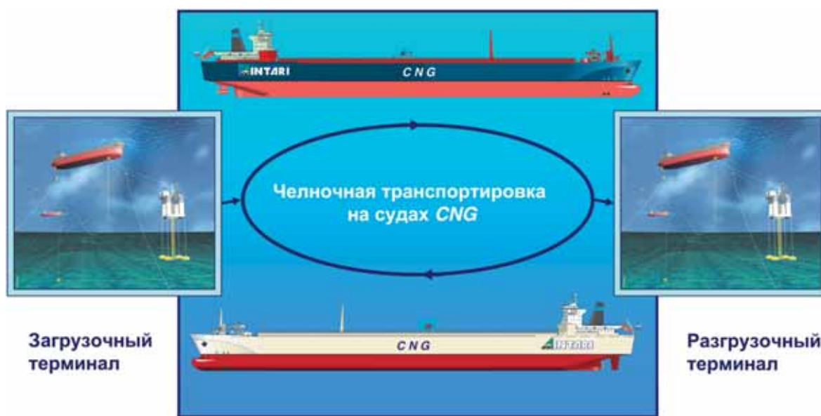
Рис. 1 Концепция морской транспортировки сжатого природного газа на судах CNG
